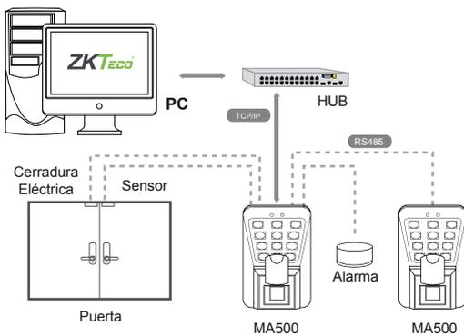
Conexión con Paneles inBIO
